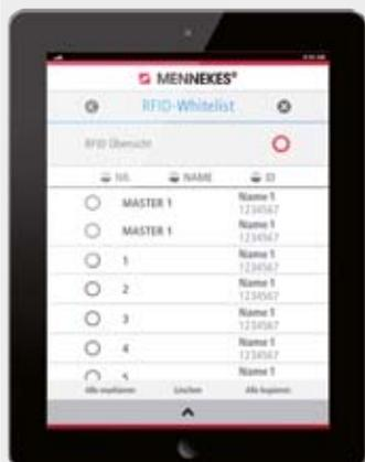
In Verbindung mit der MENNEKES Charge APP kann die lokale Whitelist zur RFID-Autorisierung besonders komfortabel genutzt werden. Hier können den RFID-Kartennummern zusätzlich Namen zugewiesen werden und die Whitelist kann bequem mit dem Smartphone bzw. Tablet verwaltet werden.
