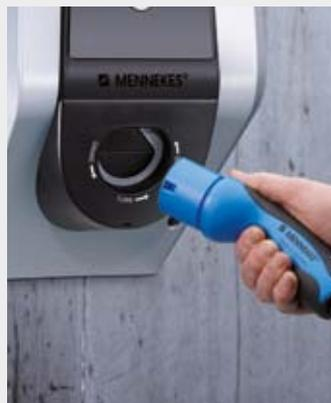
Der Ladestecker Typ 2 wird in den grauen Ring der Steckdose geführt und um ca. 60° nach links gedreht. Hierdurch öffnet der Shutter und der Stecker kann vollständig gesteckt werden. Wenn die Ladung beendet ist, kann der Stecker einfach herausgezogen werden. Der Shutter schließt sofort selbsttätig und die Kontakte sind wieder gegen Berühren geschützt. Somit ist sichergestellt, dass die Kontakte niemals frei zugänglich sind.
