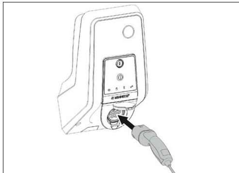
Bild: 21. Sätta i laddkabeln
